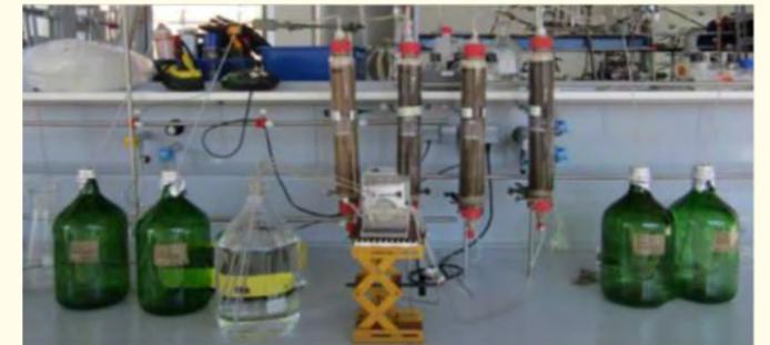
Aufbau eines Säulenperkolationsverfahrens im Labor [Quelle: TZW: DVGW-Technologiezentrum Wasser]
