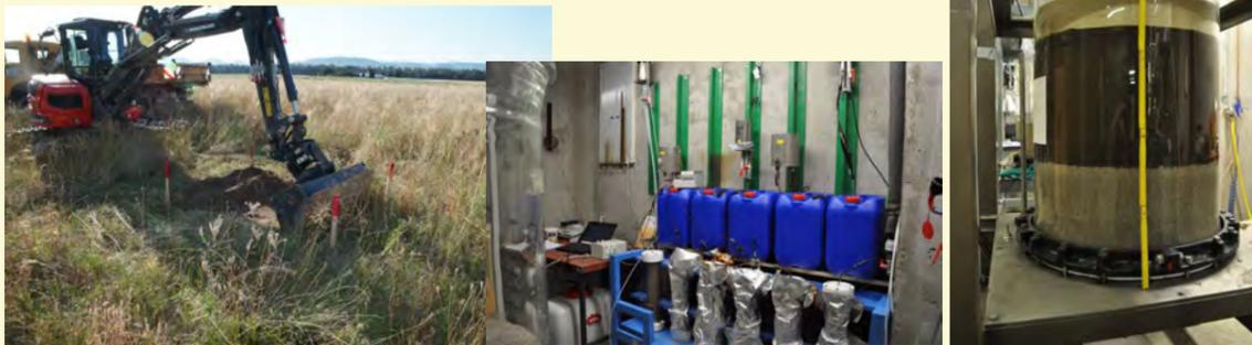
Bodenprobenentnahme aus dem Raum Rastatt (Bild links) und experimentelle Komponenten der Test-Strategie im Labor: Säulenversuch (Bild Mitte) und Lysimeterversuch (Bild rechts)
