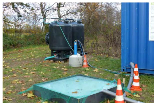
Mobile Reinigungsanlage (Sensatec) des Pilotprojektes zur Auswaschung der PFAS aus dem Boden (Kla)
